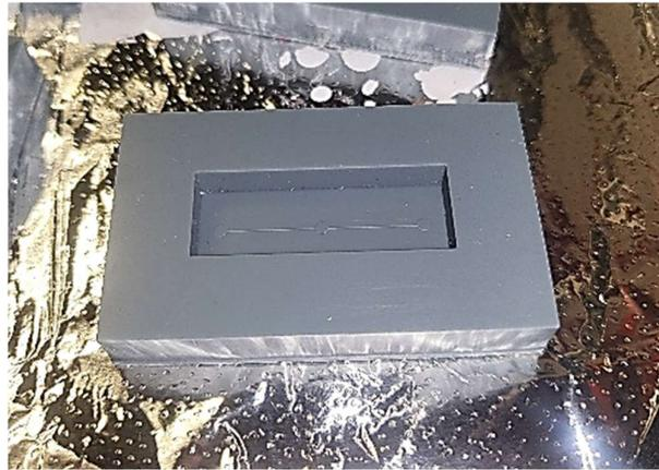
**Figura 9.** Molde maestro fabricado en resina mediante impresión 3D.
