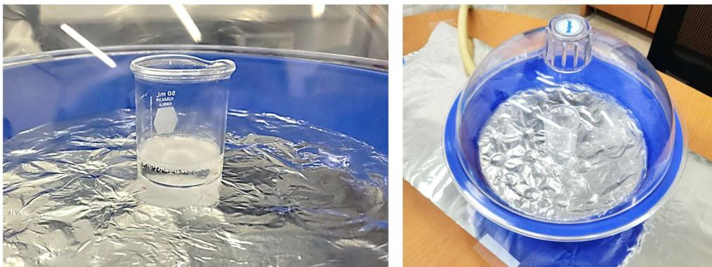
**Figura 10.** Vaso de precipitado con PDMS y extracción de burbujas por medio de vacío.
