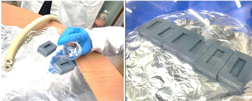
**Figura 11.** Vertido del PDMS al molde maestro y eliminación de burbujas por vacío.
